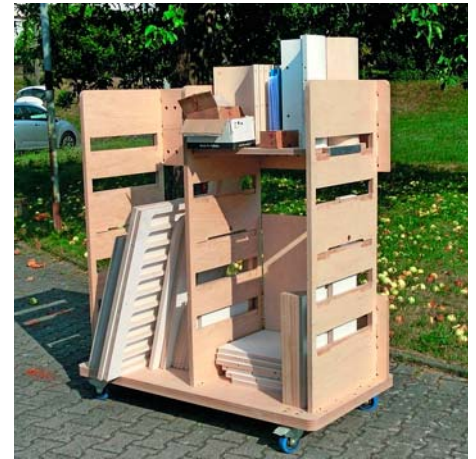
/ Der neue, zerlegbare Kommissionierwagen bietet vertikale und horizontale Lagermöglichkeiten, ...
