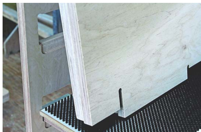
/ Auf Fasern sicher gebettet: Spezielle Bürsten gewährleisten den schonenden Transport empfindlicher Werkstoffe (Houben GmbH Fabrik technischer Bürsten).
